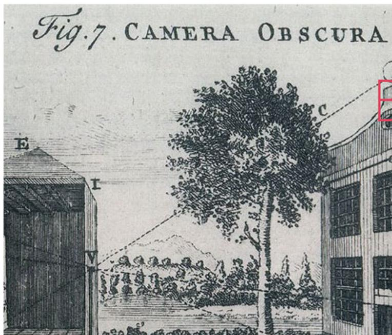
En esta ilustración se puede ver una cámara oscura del tamaño de una casa (E). A través del estenopo (V) se proyecta la imagen de la casa que está al frente de la cámara (B) en la pared opuesta al estenopo de la cámara (H). De esta forma el dibujante podía entrar en esta casa y "calcar" la imagen proyectada de la casa de enfrente.
